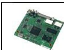
**FFT-1** - encoder/decoder per la visualizzazione sul display TFT dei modi RTTY e PSK-31, CW e CW Auto-zero in
