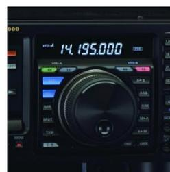
**Visualizzazione indipendente della frequenza**, quella del VFO-A è posta sopra la manopola di sintonia, mentre quella del VFO-B è presente nell'ampio display LCD da 3,5".
